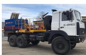
**Цементировочный агрегат СИН35.64 (давление 70МПа) на шасси MAZ317F9 без ВПБ**
