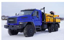
**Буровая установка АЗА-3М на шасси Урал NEXT 4320-72 со
