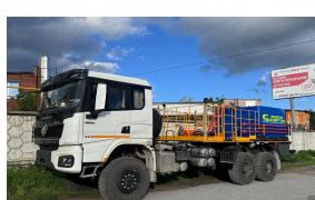
**Цементировочный агрегат СИН-35 на шасси Shacman SX32586V385**
