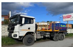
**Цементировочный агрегат СИН-35 на шасси
